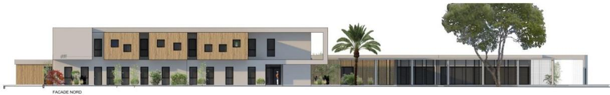
Le bâtiment est construit en briques de terre cuite isolante du type BGV'THERMO de BIO BRIC, et comprend une isolation thermique par l'intérieur.
